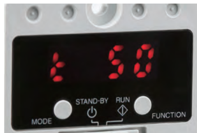
Anzeige bei einem Lastfaktor von 50 %
